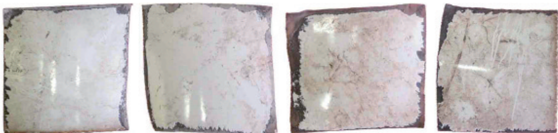
Figura 4 - Analisi visiva dei campioni di canna fumaria riscaldati a 20 °C, 150 °C, 225 °C, 300 °C (da sinistra a destra)
