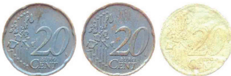
Figura 18 - Analisi visiva delle monete riscaldate a 750 °C, 900 °C, 1050 °C (da sinistra a destra)
