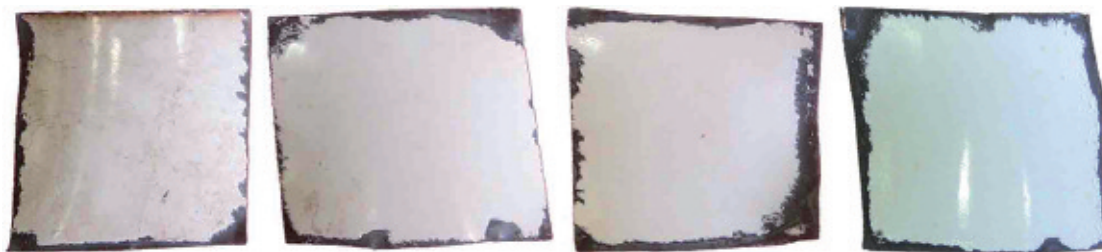
Figura 5 - Analisi visiva dei campioni di canna fumaria riscaldati a 375 °C, 450 °C, 525 °C, 600 °C (da sinistra a destra)
