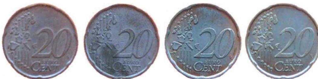
Figura 17 - Analisi visiva delle monete riscaldate a 375 °C, 450 °C, 525 °C, 600 °C (da sinistra a destra)
