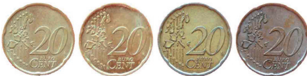
Figura 16 - Analisi visiva delle monete riscaldate a 20 °C, 150 °C, 225 °C, 300 °C (da sinistra a destra)
