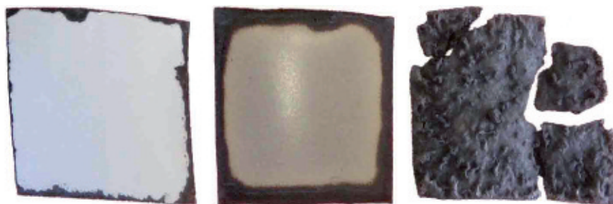
Figura 6 - Analisi visiva dei campioni di canna fumaria riscaldati a 750 °C, 900 °C, 1050 °C (da sinistra a destra)
